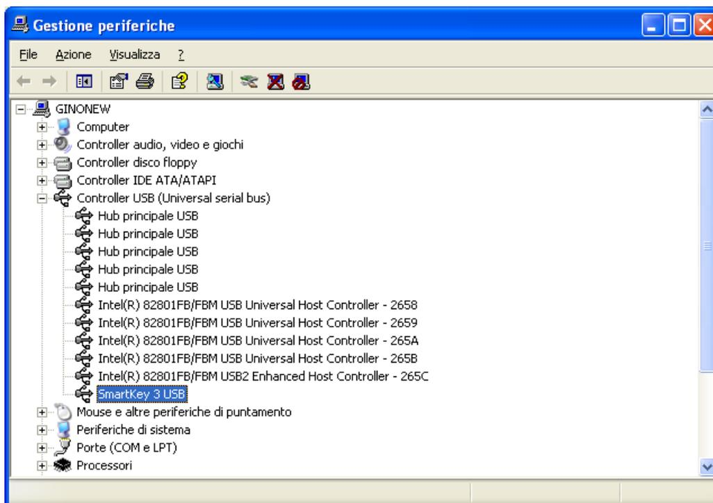
Nel caso in cui l'installazione di uno dei driver non dovesse andare a buon fine cliccate sul tasto **Elimina**, verrà richiesto di riavviare il PC, una volta eseguito il reboot, cliccate nuovamente sul tasto **Installa** per eseguire nuovamente l'installazione del driver.
